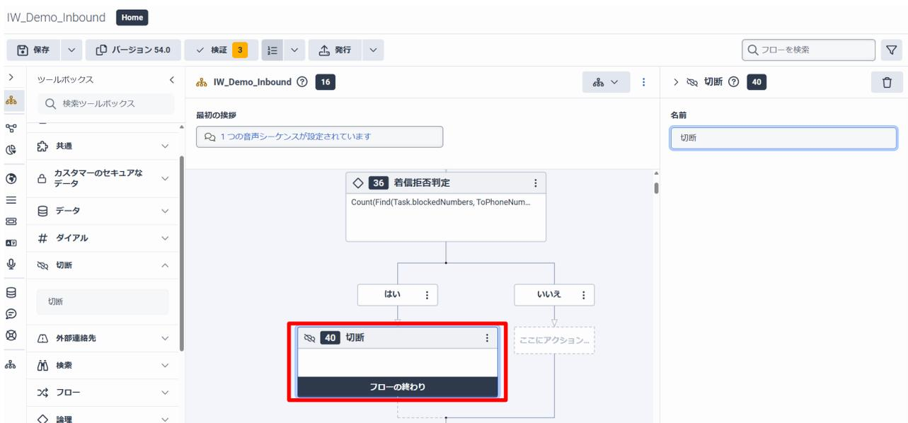
④必要に応じて切断時にメッセージを流すことも可能です。「ツールボックス」の「音声」から「音声の再生」を選択して「切断ボックス」の上の矢印上にドラッグします。音声の再生設定方法は省略させていただきます。
