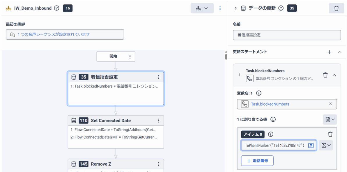
⑰着信拒否の判定を行うボックスを作成します。「ツールボックス」から「論理」の▽をクリックして、「判定」をクリックしてから着信拒否設定ボックスの下までドラッグします。
